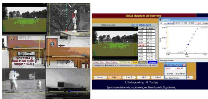
Σχήμα 1. α) Οι αναπαραστάσεις βίντεο των έξι δραστηριοτήτων της σειράς, β) Παράθυρο βίντεο με εμφανή τα ίχνη των μετρήσεων, πίνακας τιμών, παράθυρο διαγράμματος θέσης-χρόνου και παράθυρο προσεγγιστικής καμπύλης
